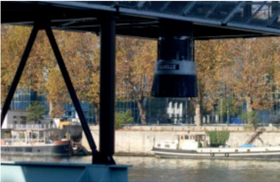
Der Stanelle JET-Belader TYP **RONDO 350 / 400 / 500** mit verlängertem Hub eignet sich zur Schiffs- und Haldenbeladung. Über den Absaugstutzen kann die erforderliche Abluftmenge von ca. 2000 - 3000m<sup>3</sup>/h mit einer entsprechenden Entstaubungsanlage abgesaugt werden.
