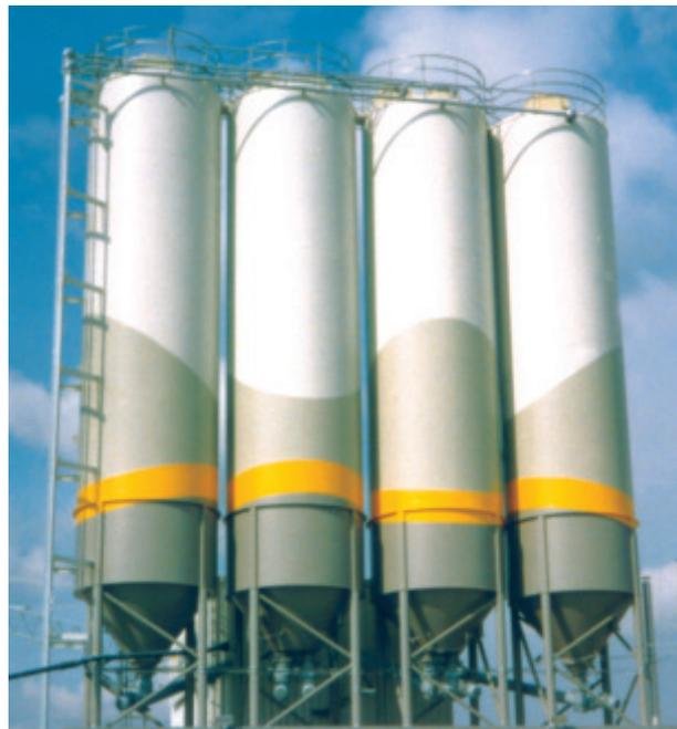
Für schwerauslaufende Medien müssen steilere Konusneigungen verwendet und der Austrag des Schüttgutes durch spezielle Austragshilfen z.B. Stanelle Luftauflockerungen LUALO oder Austragschwingkorb ASK unterstützt werden.
