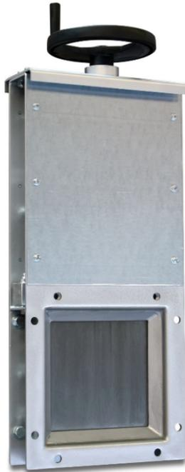
Der **Flachschieber TYP SMFS** wird an Silo- und Behälterausläufen eingesetzt. Er garantiert optimale Abdichtung bei Lagerung von staubhaltigen oder granulatförmigen Schüttgütern bis 8 mm Korngröße. Die Ausführung „Handschieber“ dient als Not-Absperrschieber. Der modular aufgebaute Schieber ermöglicht bei gleichem Grundrahmen den Anbau der verschiedenen Antriebsarten Hand-, Pneumatik- und Elektromotorischen Antrieb.
