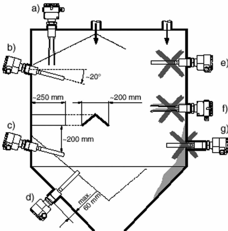
Bei der Festlegung der Einbauhöhe, ist der Böschungswinkel des Schüttkegels oder des Abzugstrichters zu berücksichtigen.
