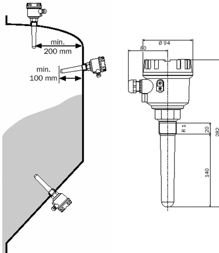
Der Böschungswinkel des Schüttkegels oder des Abzugstrichters ist bei der Wahl des Einbauortes zu berücksichtigen.
